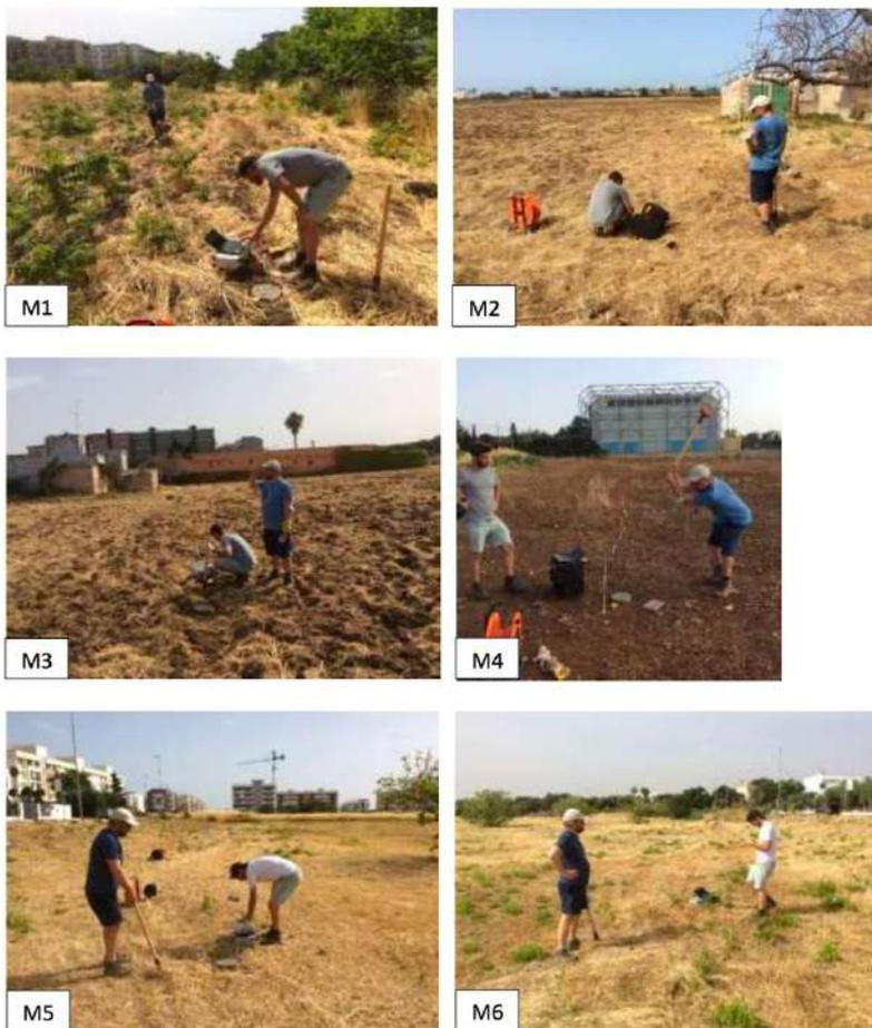
Figura 32: Prove sismiche masw realizzate – giugno 2021
